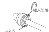
④若需拔出水管,先取下1/4"防落夹,按住夹扣头用力拔出水管。
